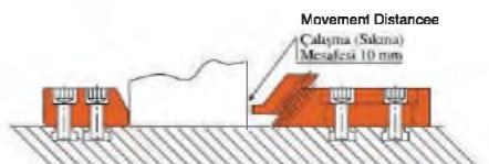
Not: Sabit dayamanın dereceli tarafı ince parçalar, düz taraf ise kalın parçalarda kullanılmak üzere iki farklı şekilde kullanılabilir.
